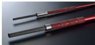
#1と#2の印籠部分はテーバー加工でスムーズに着脱が可能。#1側はSUS316、#2はチタン製。
